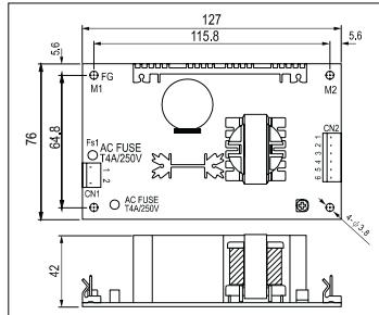
AC input voltage range .... 90~264VAC; 127~370VDC
