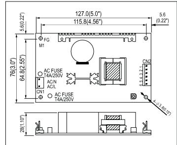
AC input voltage range .... 90~264VAC; 120~370VDC
